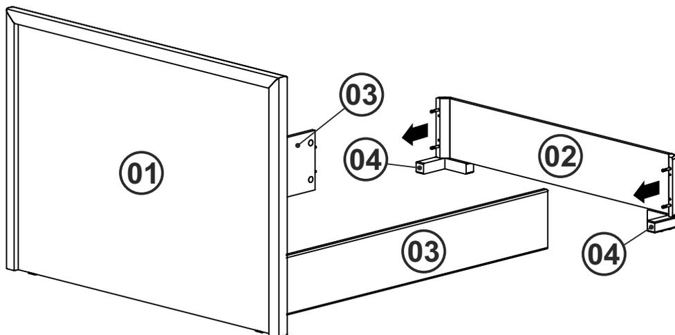
Порядок сборки сегментных стяжек аналогичен показанному при сборке головной спинки 01 и царг 03.
